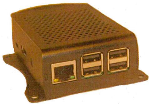
Telemetra-1はカードサイズのLinuxコンピュータRaspberry Piに低ノイズのMEMS加速度センサーを組み合わせた、安価で柔軟性に富むネットワーク地震計（強震計）です。 $25\mu\text{G}/\sqrt{\text{Hz}}$ （震度0以下に相当）の自己ノイズレベルと $\pm 2\text{G}$ （ $\pm 4\text{G}/\pm 8\text{G}$ も選択可）までの測定範囲を持ちますので、強震計としては十分な性能を持っています（微小地震観測には向きません）。
