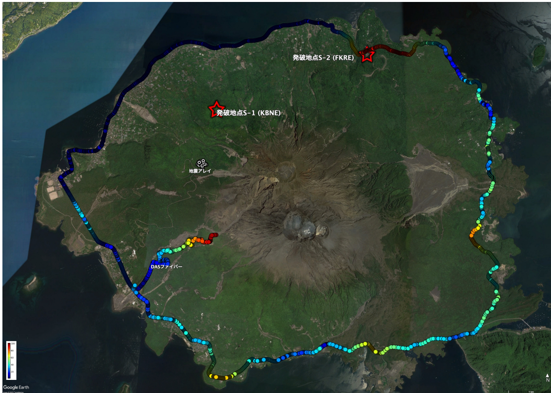
図4 地震計アレイ、Distributed Acoustic Sensingの光ファイバーのルート、発破実施の位置
