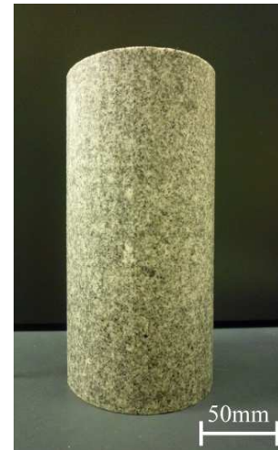
写真 1. 計測に使用した大島花崗岩試料。
