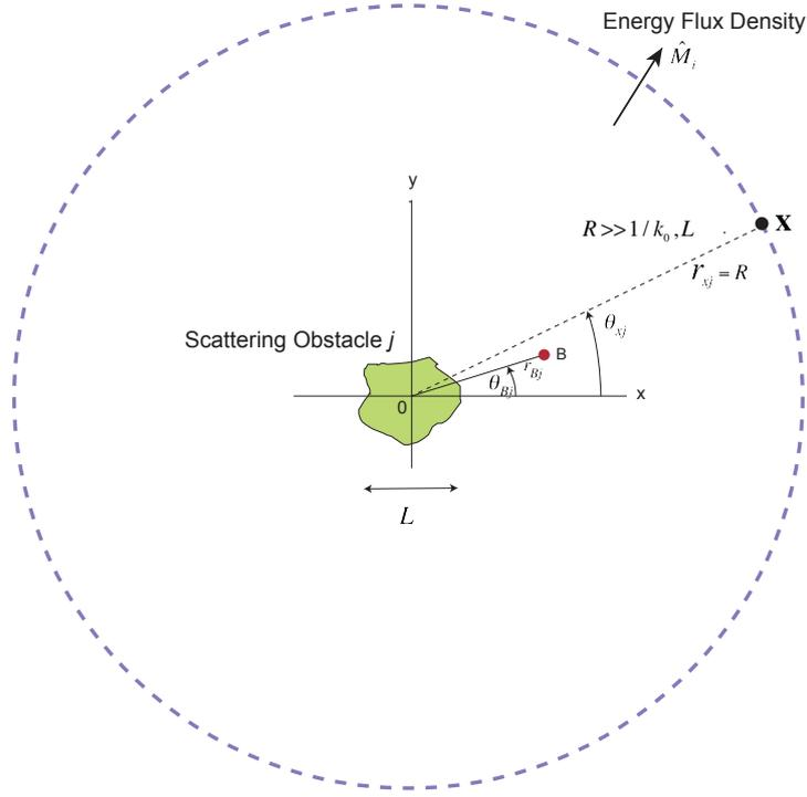
図2 震源Bと散乱体  $j$  を取り囲む円環上でエネルギー流束密度  $\widehat{M}_r$  の線積分は全エネルギー流束を与える。
