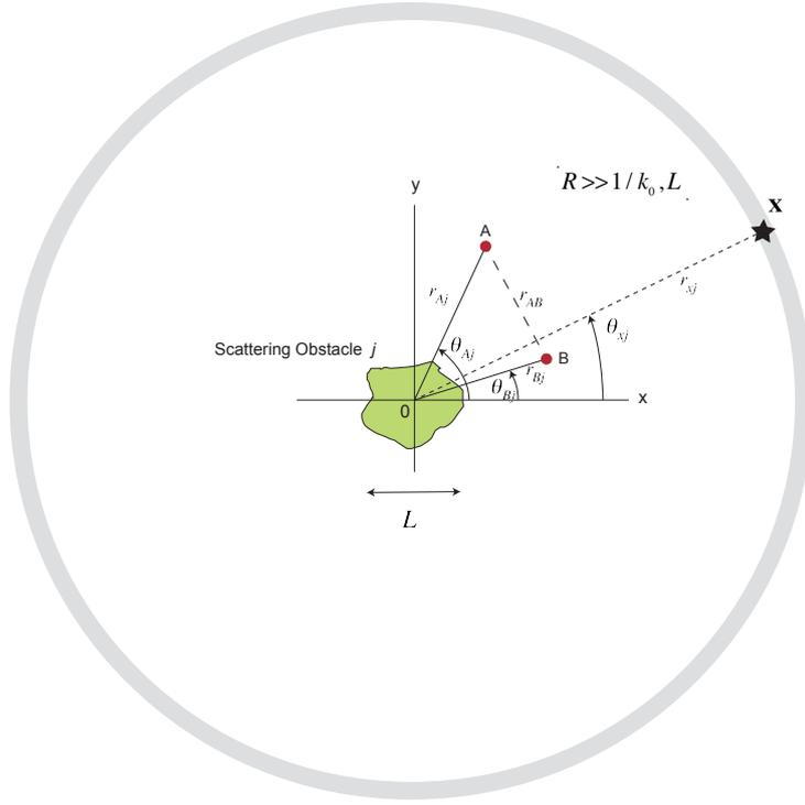
図1 散乱体  $j$  と観測点 A と B は、十分大きな半径の円環の上に分布する互いに無相関な定常ランダム震源によって照射されている。
