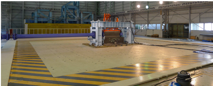
図1(上). 大型振動台上に載荷装置と岩石試料を設置した様子。(下). 載荷装置と岩石試料, 振動台の模式図。
