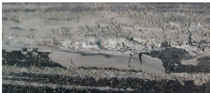
図2(上). 固着すべり後の試料表面の様子。(下). すべり条痕の拡大。
