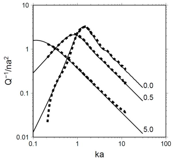
図 2. 散乱減衰  $Q^{-1}$  の波数依存性。太い点線が FDM による数値実験の結果 ( $na^2 = 0.013$ )、細い実線が Foldy 近似理論による予測値をそれぞれ示す。図中の数値は  $\sigma$  値である。
