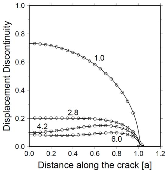
図 1. 亀裂の相対剪断変位( $\sigma = 0.5$ ,  $\Delta h = a/80$ ,  $\Delta t = 0.003a/\beta$ )。実線が FDM、○が BIEM の計算値をそれぞれ示し、図中の数値は  $ka$  の値である。横軸は亀裂中心からの距離。縦軸は  $ka = 0$  で亀裂中心での変位が 1 となるように規格化している。
