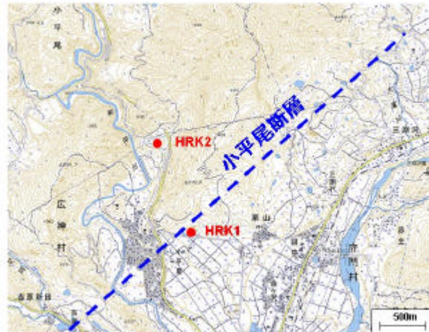
図 4 小平尾断層における断層トラップ波の観測。HRK1 : 断層直上、HRK2 : 岩盤基準点。
